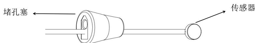
图 A2.2 阻尼振动传感器布置示意图
