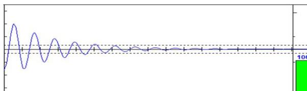
图 A.3 检测时套筒灌浆饱满波形图
