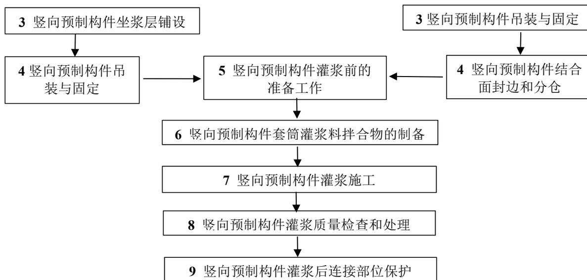
**5.4.2** 竖向预制构件吊装就位前，应按下列规定对预制构件与现浇结构的结合面施工质量和预制构件进行检查。
