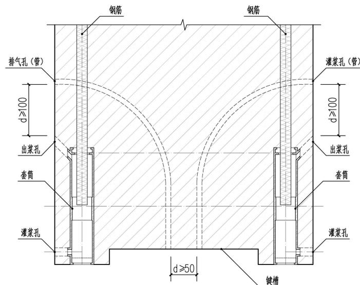
预制柱键槽部位排气孔和灌浆孔设置示意图1
